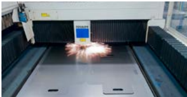
Uitlaseren van stalen plaatmateriaal
