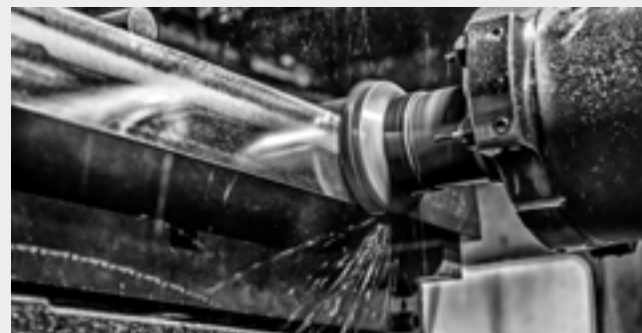
Frezen van de zijkanten van de gietijzeren tafels
